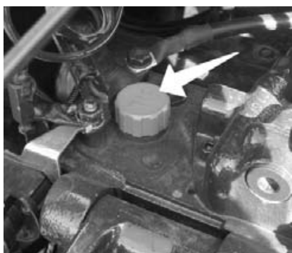
Fig 9 - Bouchon de remplissage d'huile dans la transmission
