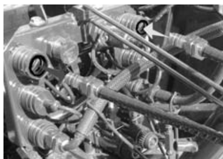
Fig. 3 - Sens du débit d'huile avec le levier en position montée - ROUGE
